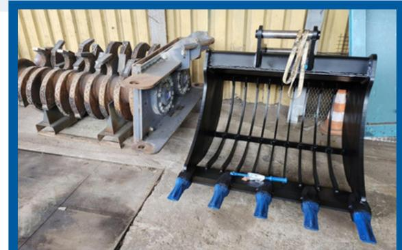
“ *La forme standard “S” est une dent longue et plate. Ce profil est idéal pour le terrassement et un multi-usage standard car elle assure une bonne pénétration et une résistance à l'abrasion.* ”
