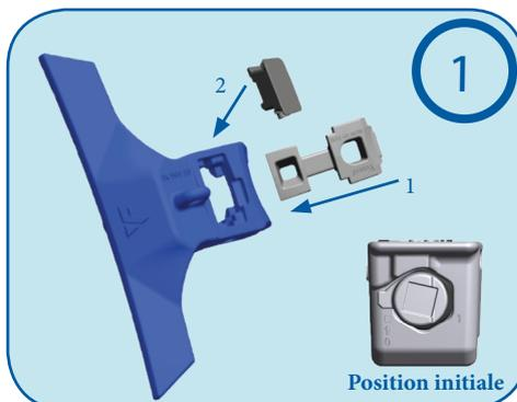
**Préassemblage :** Préassembler manuellement la base, le bouclier et le clavetage.
