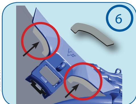
**Instruction de soudure (étape 3) :** Après avoir installé et verrouillé le clavetage, nous vous recommandons de souder des supports de bouclier, dans le simple but d'absorber les efforts sur les flancs.
