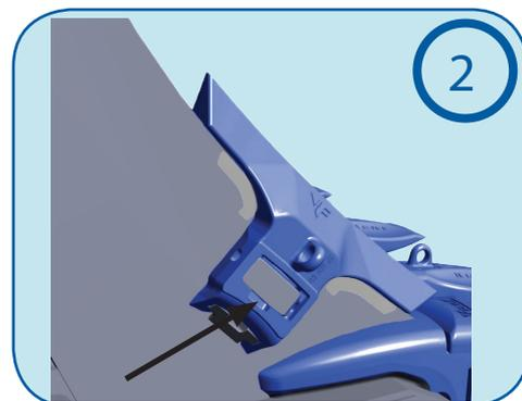
**Dégagement du clavetage :** Avec le pied de biche présent sur l'outil, insérer ce dernier dans la fente et faire levier pour l'extraire.
