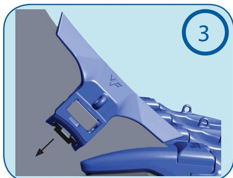
**Positionnement du bouclier :** Incliner le godet vers le haut suivant un angle de 30° environ. Plaquez le bouclier contre le plat du flanc, afin d'être en bûte.
