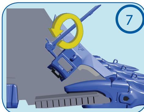
**Verrouillage du clavetage :** Une fois la soudure des supports réalisée ; réassembler le bouclier sur la base et installer le clavetage. Prendre l'outil de démontage, insérer-le dans le logement, et accomplissez le verrouillage par rotation de 180° dans le sens inverse des aiguilles d'une montre. Une fois verrouillé vous serez alors en butée et il est inutile de forcer plus loin.
