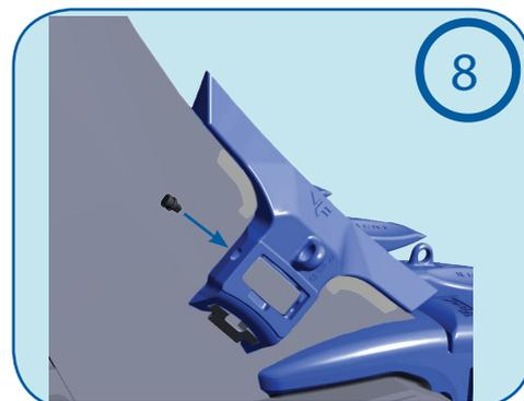
**Installation du bouchon de protection :** Insérer le bouchon de protection du clavetage pour limiter l'entrée de matériaux dans le carré de clavetage
