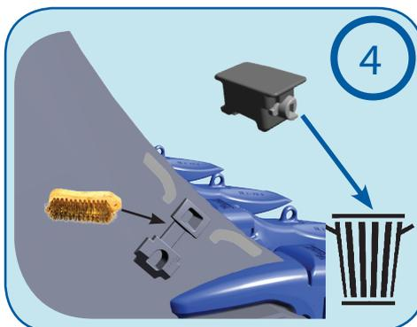
**Nettoyage de la base :** Nettoyer la base et l'emplacement du clavetage, et jetez le vieux clavetage à la poubelle. La base est prête pour recevoir un bouclier neuf.
