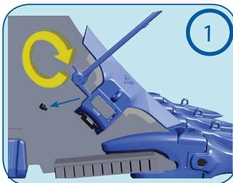
**Déverrouillage du clavetage :** Enlever le bouchon de protection et avec l'outil de démontage, insérez-le dans le logement, et accomplissez le déverrouillage par rotation de 180° dans le sens des aiguilles d'une montre.
