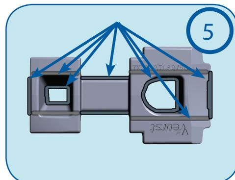
**Instruction de soudure (étape 2) :** Une fois la base correctement orientée et pointée, enlever le clavetage et le bouclier. Préchauffer la base entre 175° et 200° C, et souder sur les zones comme indiquées ci-dessus.
