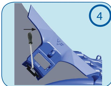
**Instruction de soudure (étape 1) :** En vous servant d'un tournevis, tirer la base en arrière, vers l'intérieur du godet (mettre en pression l'ensemble et non en compression) et pointer derrière. Retirer le bouclier et pointer devant. Remonter le bouclier afin de vérifier son positionnement correct.
